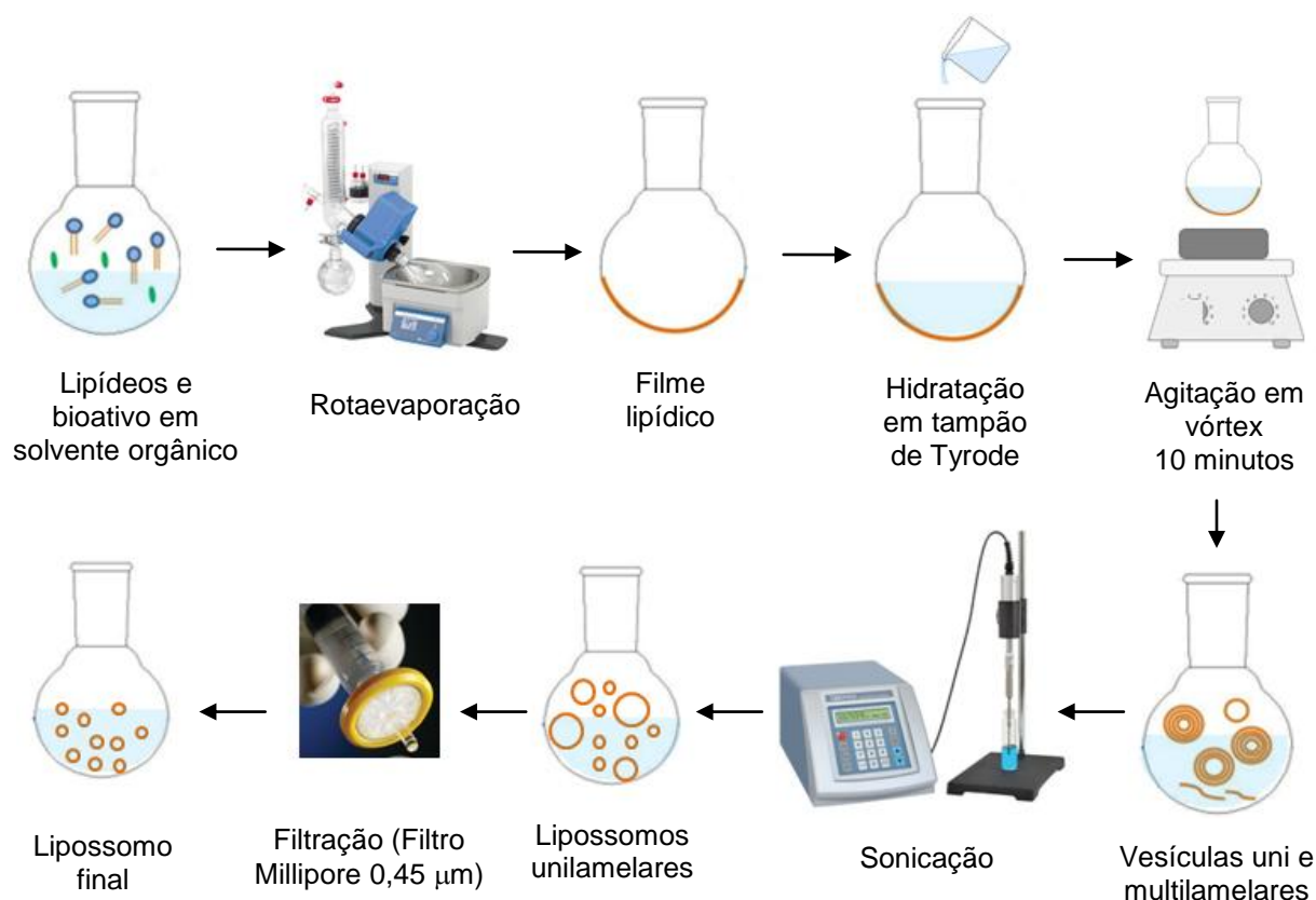
Figura 13 - Método de hidratação do filme lipídico para preparo dos lipossomos.
