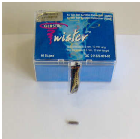
Figura 7 - Barras magnéticas SBSE revestidas com PDMS, procedentes da Gerstel. Retirada do site www.gerstel.com
