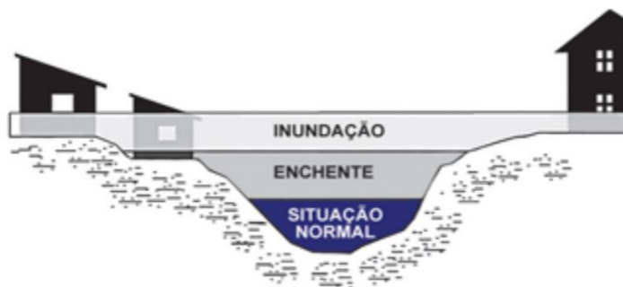
Figura 3- Perfil esquemático do processo de enchente e inundação
