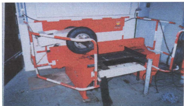
Figura 49 - Compactação de placas
