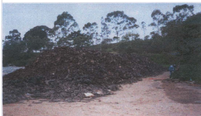
Figura 8- Pneus picados a serem misturados à pedra britada.
