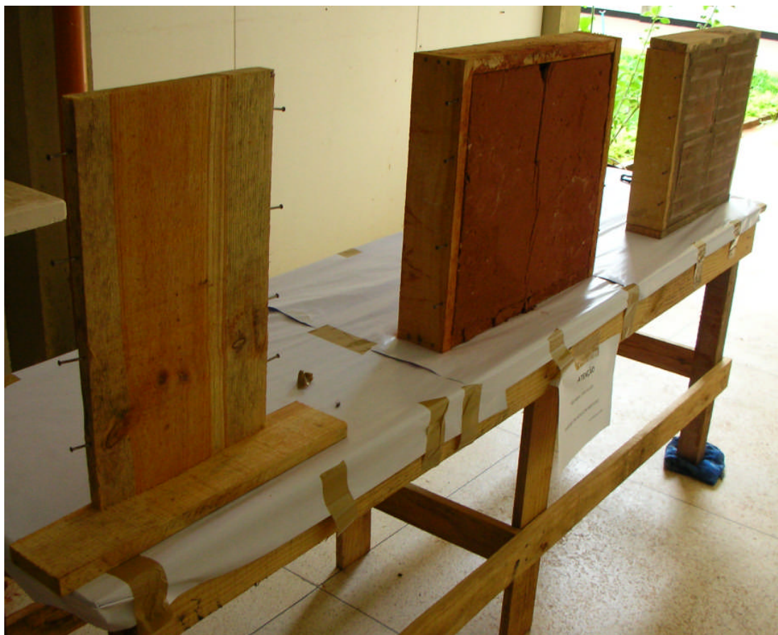
Figura 6 – Foto da parede de madeira, barro e tijolo utilizados nos bioensaios de campo.
