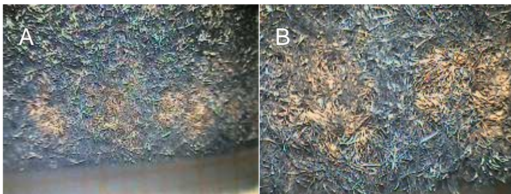
Figura 31: Micrografias ópticas do feltro/NTC-1/Cu após a reação por 5 segundos em solução de \text{CuSO}_4/\text{H}_2\text{SO}_4 concentrada.
