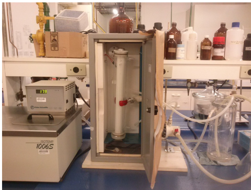
Figura III.1: Fotografia do reator fotoquímico equipado com a lâmpada de luz negra, bomba de circulação e recipiente externo com controle de temperatura.
