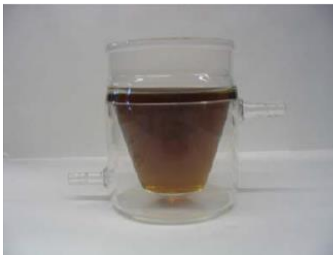
Figura 12 – Imagem da célula eletroquímica utilizada nas eletrólises para os processos de OA, EF, FEF e FEFS.
