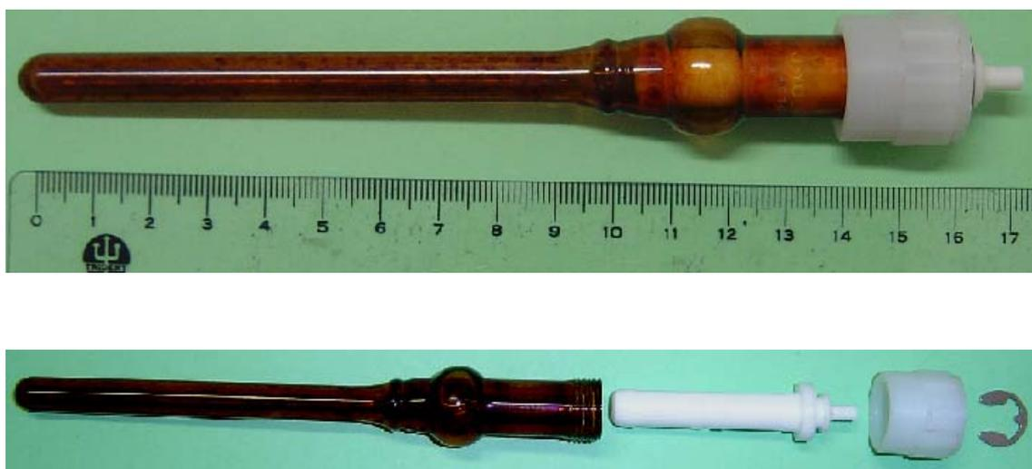
**Figura 15b – Esquema do tubo de permeação de amônia, confeccionado artesanalmente<sup>(65)</sup>.**
