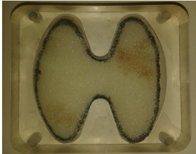
Figura 14 - Peça correspondente a tireoide do objeto simulador OSCT com espuma para permitir a distribuição não homogênea do material radioativo.
