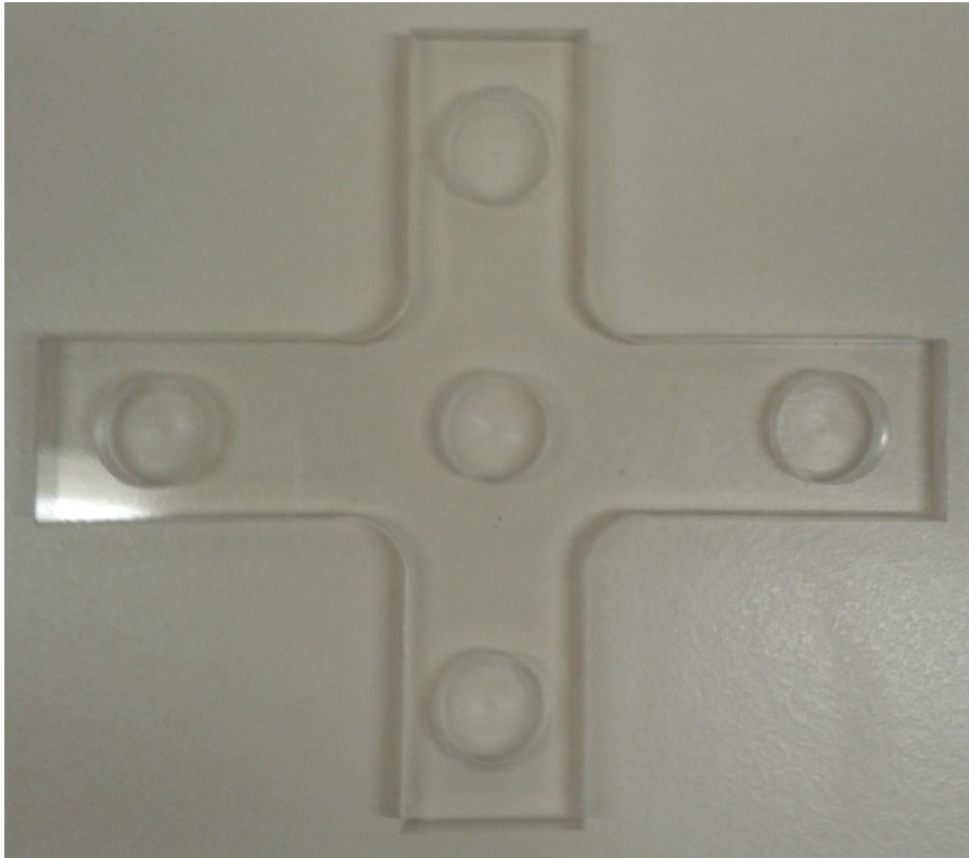
Figura 13 - Imagem das cavidades criadas em uma cruz de PMMA para o posicionamento de dosímetros sobre a fonte radioativa da tireoide.
