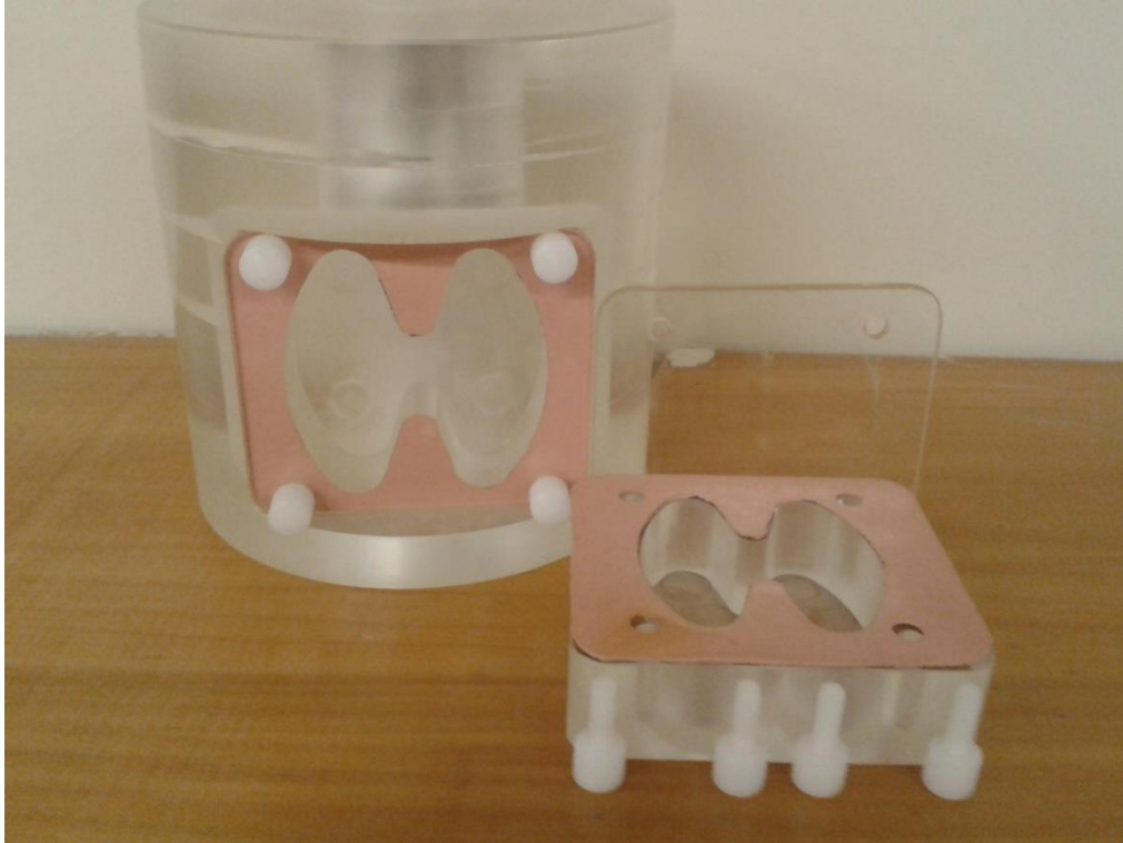
Figura 10 - Imagem do objeto simulador OSCT construído, com as adaptações da borracha e parafusos para vedar a tampa.
