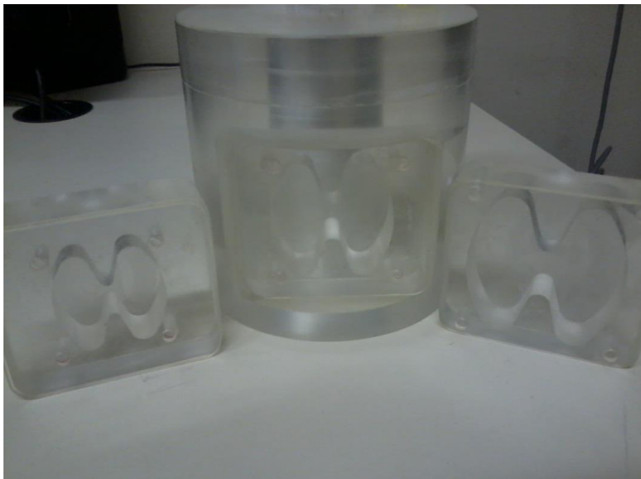
Figura 9 – Objeto simulador OSCT desenvolvido para este projeto, adaptado do trabalho de Cerqueira et al (2014). Da esquerda para a direita têm-se as caixas representando uma tireoide com hipotireoidismo, uma tireoide normal e outra com hipertireoidismo.
