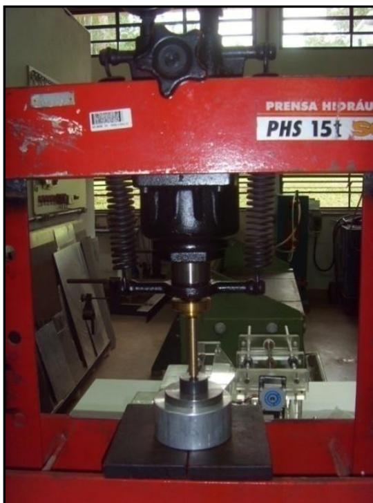
Figura 16: Posicionamento das matrizes em uma prensa no processo de manufatura da pastilha dosimétrica.
