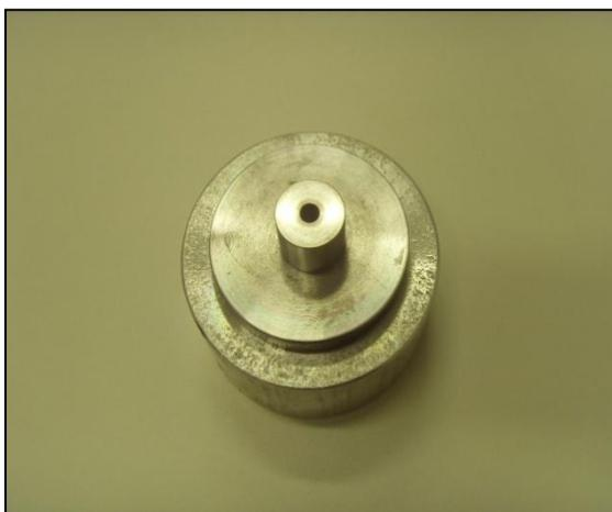
**Figura 15: Moldes para produção das pastilhas dosimétricas.**
