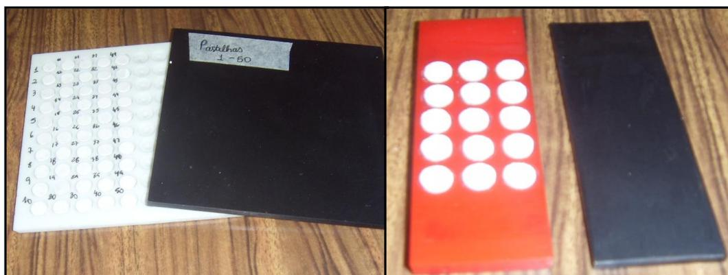
Figura 17: Pastilhas OSL armazenadas em estojos opacos para a proteção da luz ambiente.
