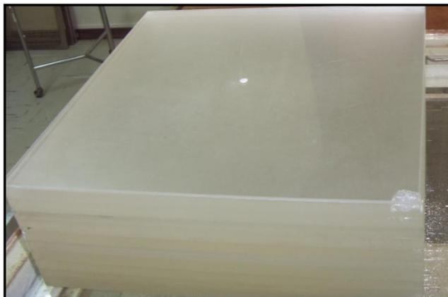
**Figura 23:** Placas de acrílico utilizadas como objeto simulador e placa de acrílico com um orifício central para o posicionamento da pastilha.
