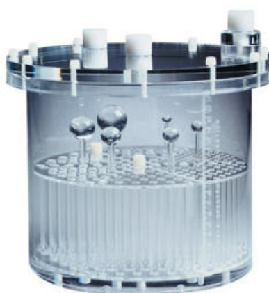
Figura 12 Simulador Jaszczak Deluxe utilizado para a aquisição das imagens
