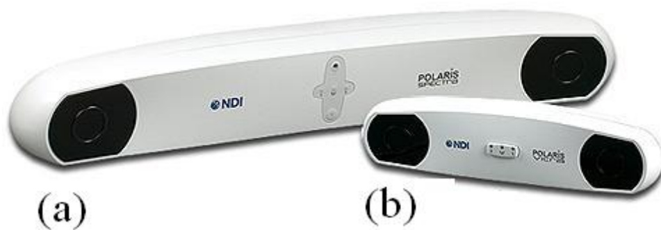
[Figura 7.3] Exemplo de sistema de rastreamento óptico (a) Polaris Spectra ® e (b) Polaris Vicra ® (Imagem retirada de [Polaris 2007]).
