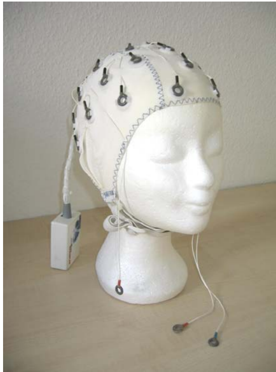
[Figura 2.2] Localização dos eletrodos sobre o couro cabeludo (Figura retirada de [Kgu 2007]).
