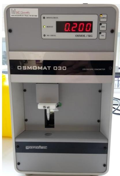
**Figura 3.6.** Osmômetro crioscópico utilizado para determinação da osmolalidade das soluções de glicose e sacarose (após preparo das GUVs).
