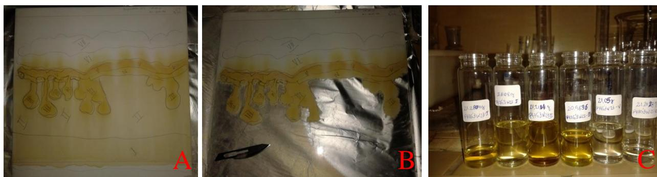
**Figura 3.3.** A) Fracionamento do extrato resinoso da própolis verde através da placa de CCD preparativa; B) Raspagem da fase estacionária relacionada às subfrações determinadas; C) Subfrações resultantes após a coleta do sobrenadante.
