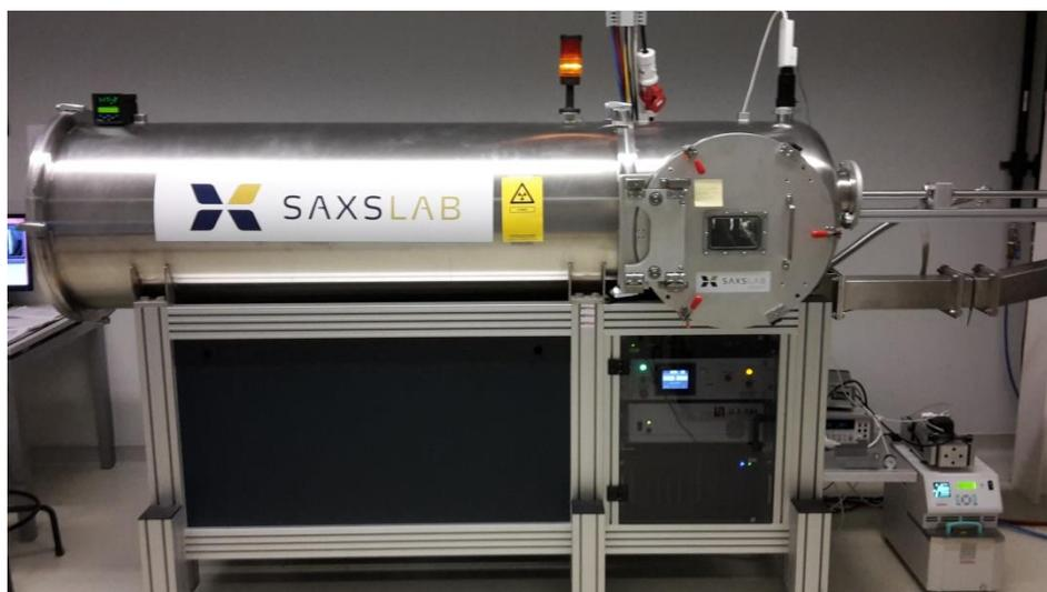
**Figura 3.7.** Equipamento SAXSLAB GANESHA 300 XL SAXS, utilizado para aquisição das curvas de espalhamento de raio-X a baixo ângulo, instalado no *Institute for Complex Molecular Systems, Eindhoven University of Technology, Eindhoven – Holanda*.
