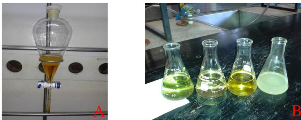
**Figura 3.1.** A) Funil de separação contendo extrato resinoso da própolis verde em uma mistura bifásica contendo MeOH/H<sub>2</sub>O (90:10 v/v) e hexano; B) Extrato resinoso da própolis verde fracionado em quatro solventes de diferentes polaridades (da esquerda para direita): hexano, acetato de etila, clorofórmio e água.
