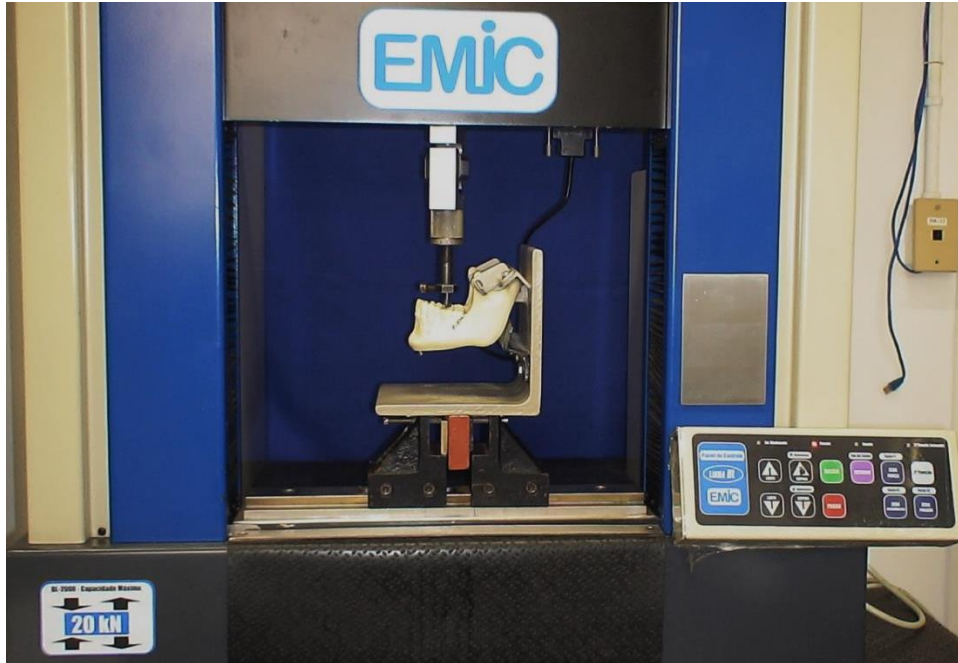
Figura 5 - Máquina universal de ensaios, da marca comercial EMIC, modelo DL200.
