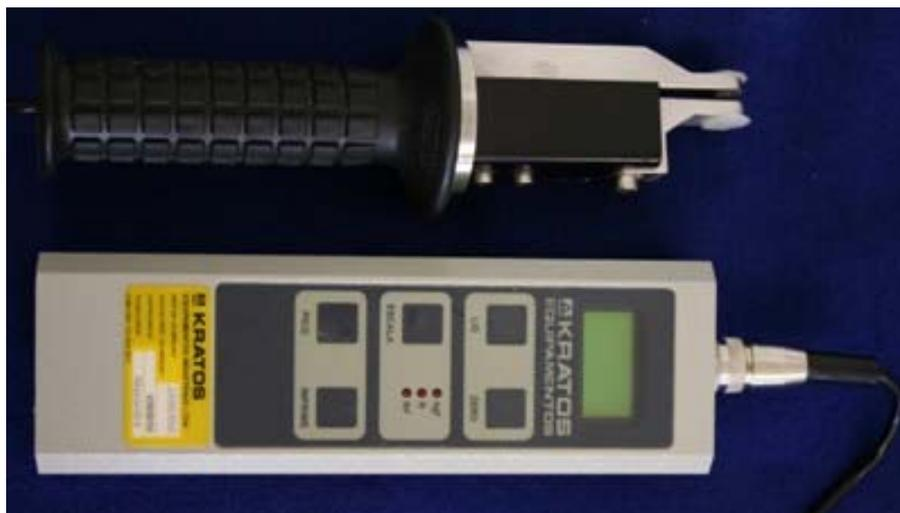
**Figura 11** . Dinamômetro IDDK Kratos®.
