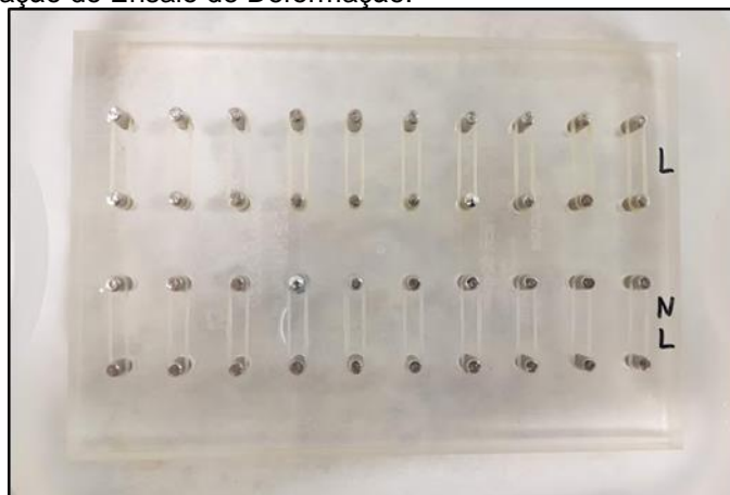
Figura 2- Placa de acrílico contendo pinos metálicos, utilizada para a fixação dos elásticos ortodônticos intermaxilares e realização do Ensaio de Deformação.
