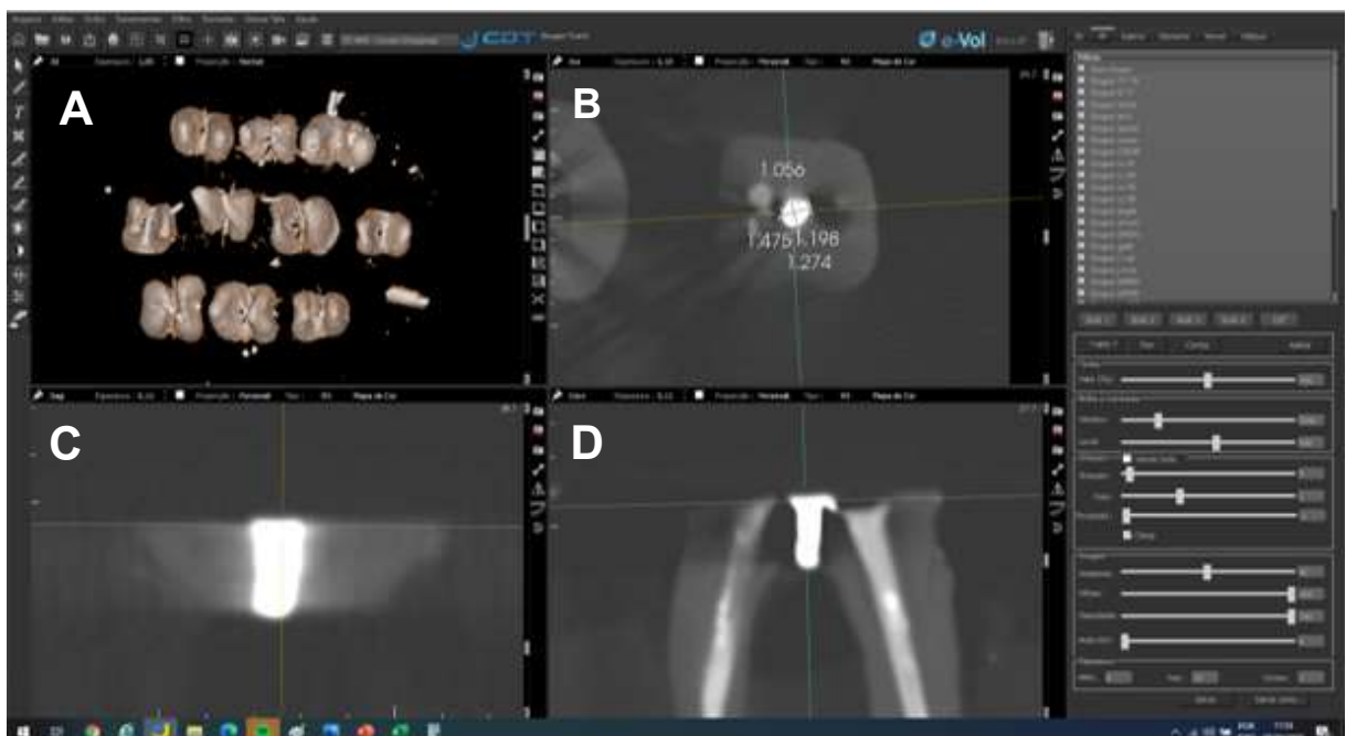
Figura 10. A) Imagem de TCFC dos espécimes agrupados do grupo Amágama; B) isolamento de cada amostra das demais dentro da aquisição, com auxílio da ferramenta “corte”, B), C) e D) inclinação nos planos de orientação anatômico (axial, coronal e sagital) de forma que a superfície cortada (face do assoalho da câmara pulpar) fique paralela ao solo.
