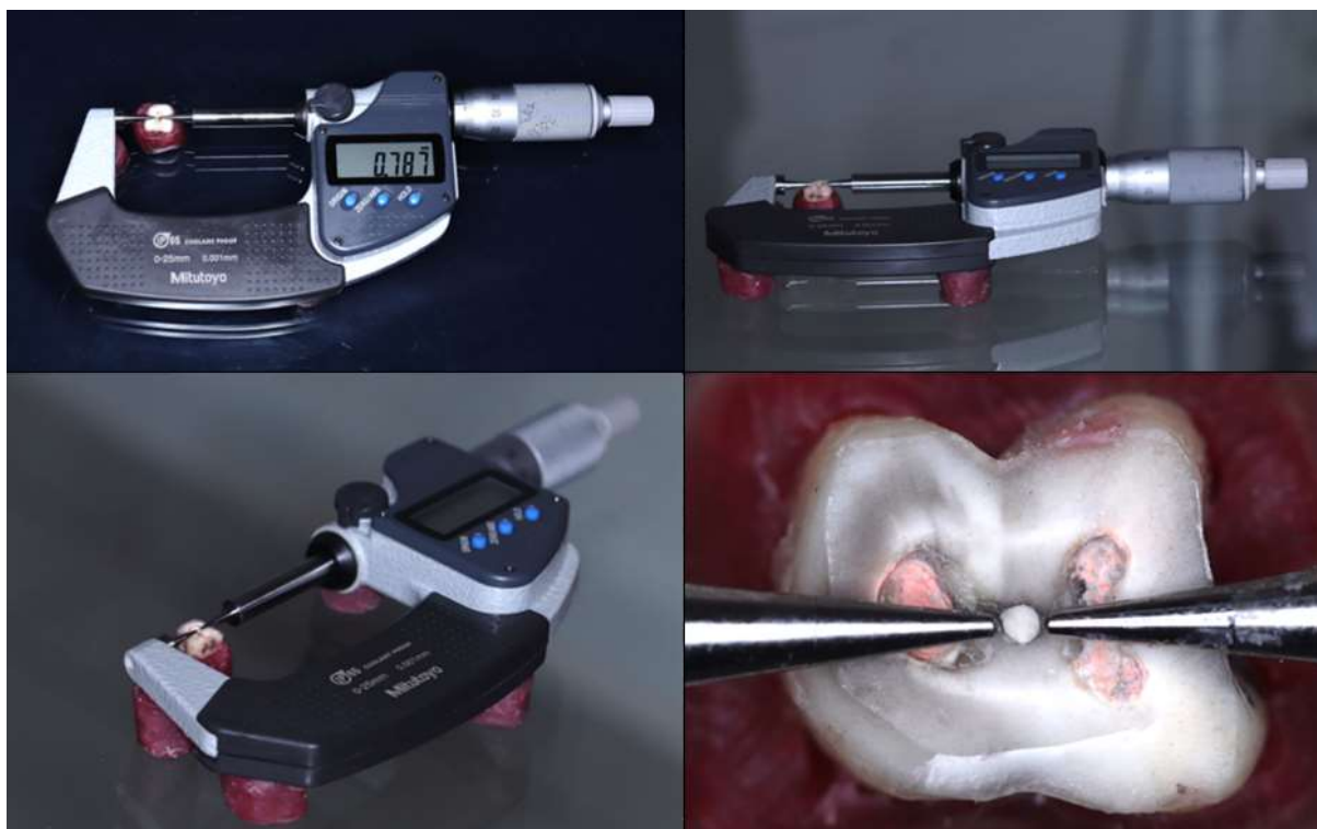
Figura 4. Ilustração da medição dos diâmetros do selamento das perfurações com micrômetro.
