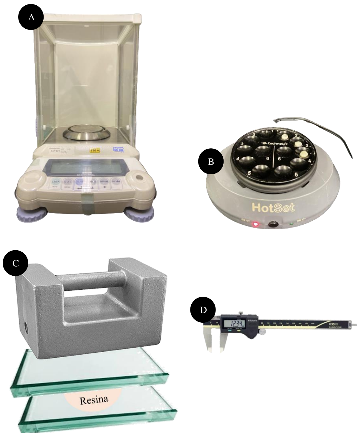
Figura 4. Etapas do teste de espessura de película. 4A: Balança de precisão; 4B: Aquecedor de resina composta; 4C: Resina entre placas de vidro sob carga; 4D: Paquímetro digital.
