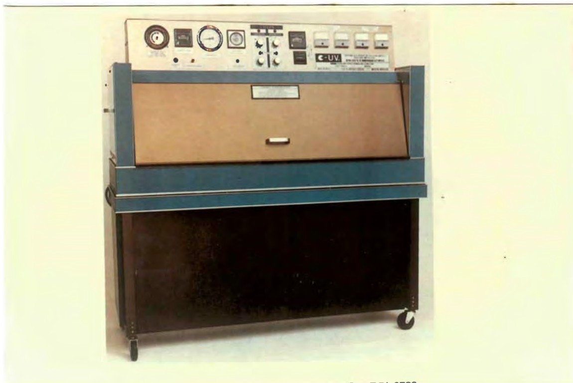
FIGURA 2 - C-UV = Sistema acelerado de envelhecimento para não metálicos.
