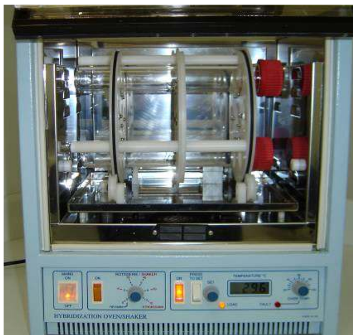
Figura 31 – Forno de hibridização utilizado para a fixação das amostras de DNA sobre a membrana, pré e hibridização das membranas, além dos procedimentos de lavagem.
