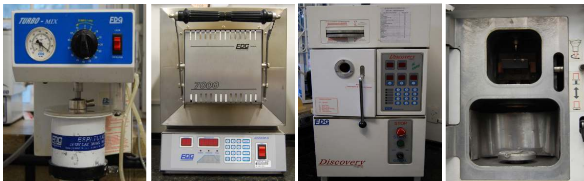
Figura 15 – A: Espatulador à vácuo; B: Forno para aquecimento do anéis de fundição; C: Máquina de fundição; D: Câmara de arco voltaico (superior) e câmara à vácuo (inferior) da máquina de fundição.
