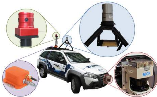
Figura 4 – Plataforma CaRINA 2, exemplificação de localização dos sensores
