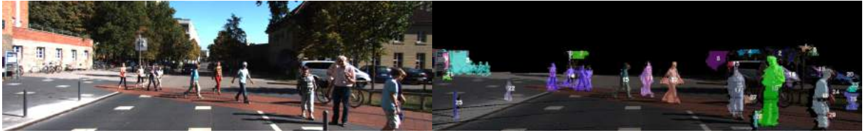
Figura 8 – Resultados da detecção para a sequência de imagens do KITTI. A primeira coluna é a imagem da câmera esquerda. A segunda representa cada obstáculo pelo seus conjuntos de pontos.
