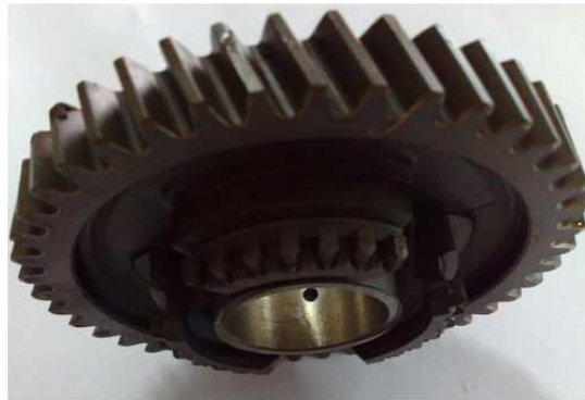
Figura 4.4: Detalhe da engrenagem do câmbio
