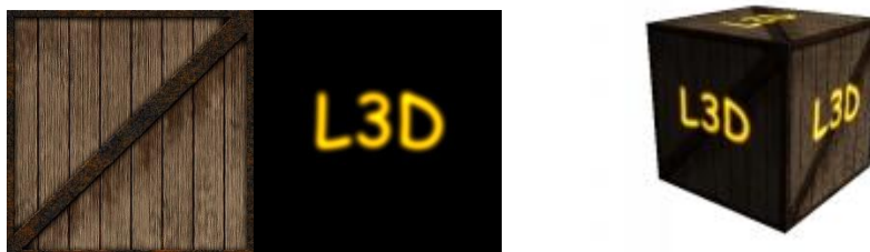
Figura 4: Exemplo de Multitexturização – Do lado esquerdo, as duas texturas bases; do lado direito, ambas as texturas aplicadas sobre o mesmo modelo, portanto sobrepostas. Disponível em: < http://www.lighthouse3d.com/OpenGL/glsl/index.php?textureMulti >. Acesso em 03 de março de 2008.
