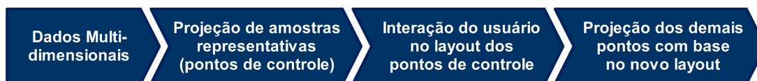
Figura 1.1: Pipeline das técnicas de projeção que permitem a interação do usuário no layout da projeção, através da manipulação de amostras representativas.
