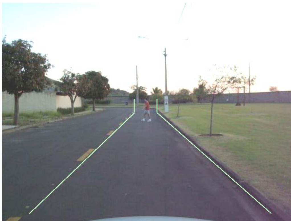
Figura 27 – Exemplo da área de risco
