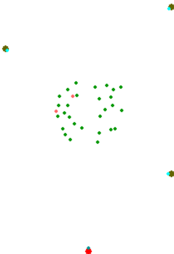
Figura 63 – Instante inicial do terceiro cenário de testes na escala macro. O círculo vermelho maior é a pessoa que será acompanhada, os círculos azuis ao lado identificam a direção das pessoas, os demais círculos maiores representam outras pessoas e os pequenos losangos são os robôs.
