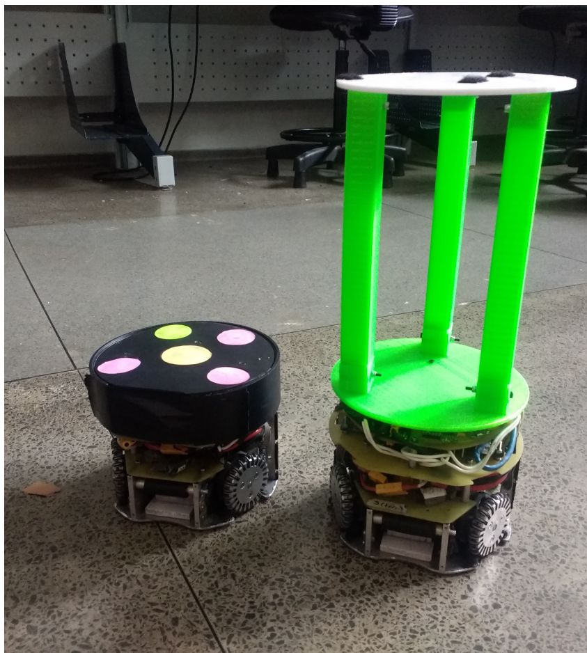
Figura 71 – Robô utilizados no experimento sem a base adicional (esquerda) e com a base impressa (direita).
