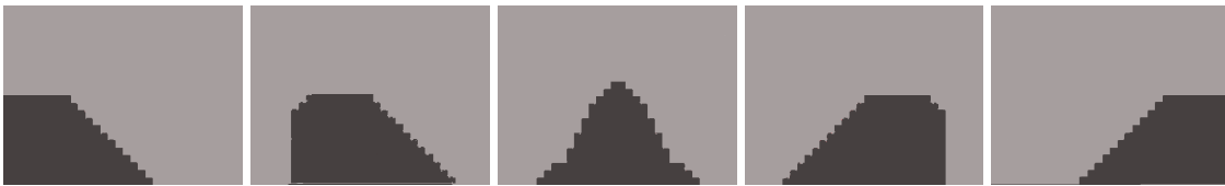
Figura 5.10: Cinco possíveis geometrias definindo as direções que o veículo pode seguir. Da esquerda para a direita: curva acentuada para a esquerda, curva leve a esquerda, em frente, curva leve a direita, curva acentuada a direita.
