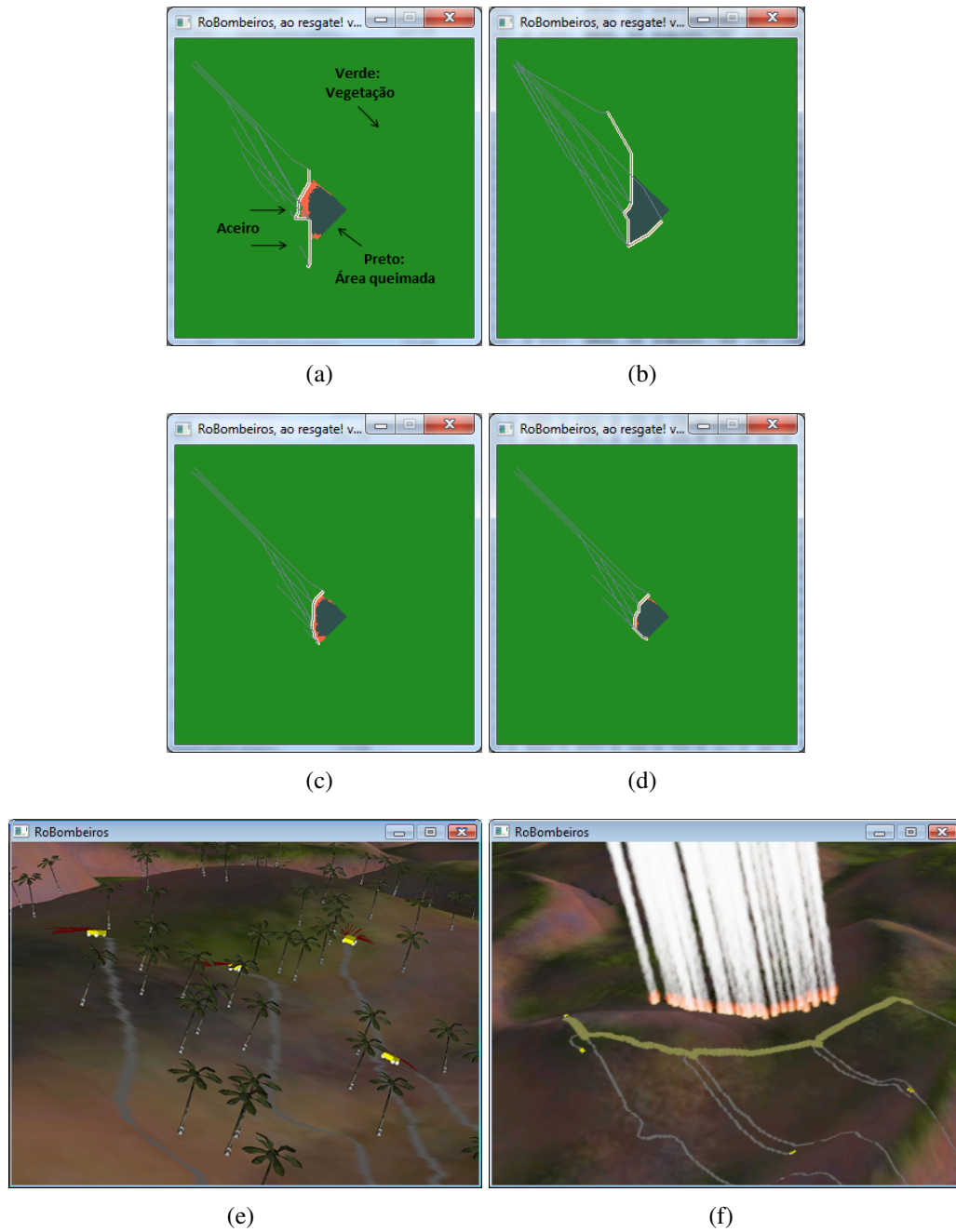
Figura 6.5: (a) e (b) Resultados insatisfatórios, os aceiros são excessivamente grandes e mal distribuídos entre os robôs. (c) e (d) Resultados satisfatórios. (e) Visão detalhada da navegação dos robôs móveis. (f) Resultado satisfatório aplicado no protótipo 3D.
