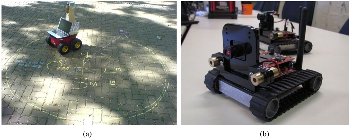
Figura 5.3: Robôs de pequeno porte. (a) Setup do experimento usando o robô Pioneer P3-AT. (b) Robô de pequeno porte SRV-1Q (Surveyor, 2010).
