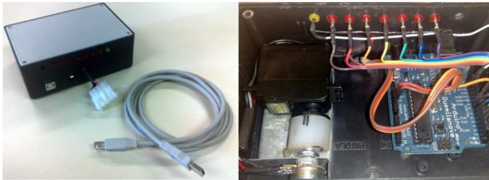
Figura 5.5: Dispositivo controlador de aceleração (Fernandes et al. , 2012). Na direita, vista do interior com destaque para o controlador Arduino (Arduino, 2013) e o acoplamento mecânico entre servo motor e potenciômetro.
