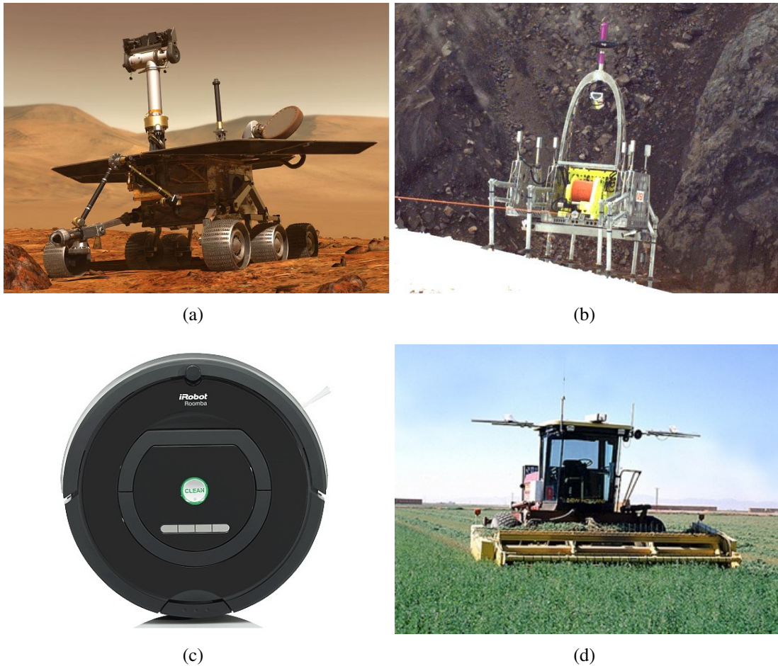
Figura 2.2: Robôs de campo: (a) Mars Exploration Rover (JPL/NASA, 2013) para exploração espacial; (b) Dante II (Bares e Whittaker, 2013) para exploração de cavernas e vulcões. Robôs de serviço: (c) Aspirador de pó Roomba (iRobot, 2013); (d) Colheitadora autônoma (NREC/CMU, 2013).
