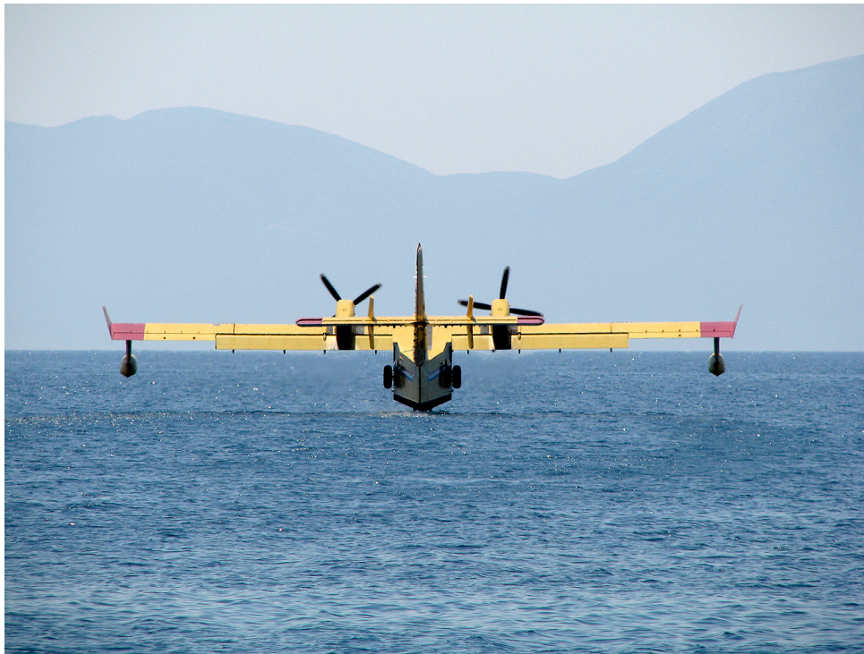
Figura B.1: Avião-tanque Canadair CL-415 (Bombardier, 2007), transporta 6 t de água, abas-tece sem pousar em uma superfície de água com 1,2 km de comprimento e 2 m de profundidade.
