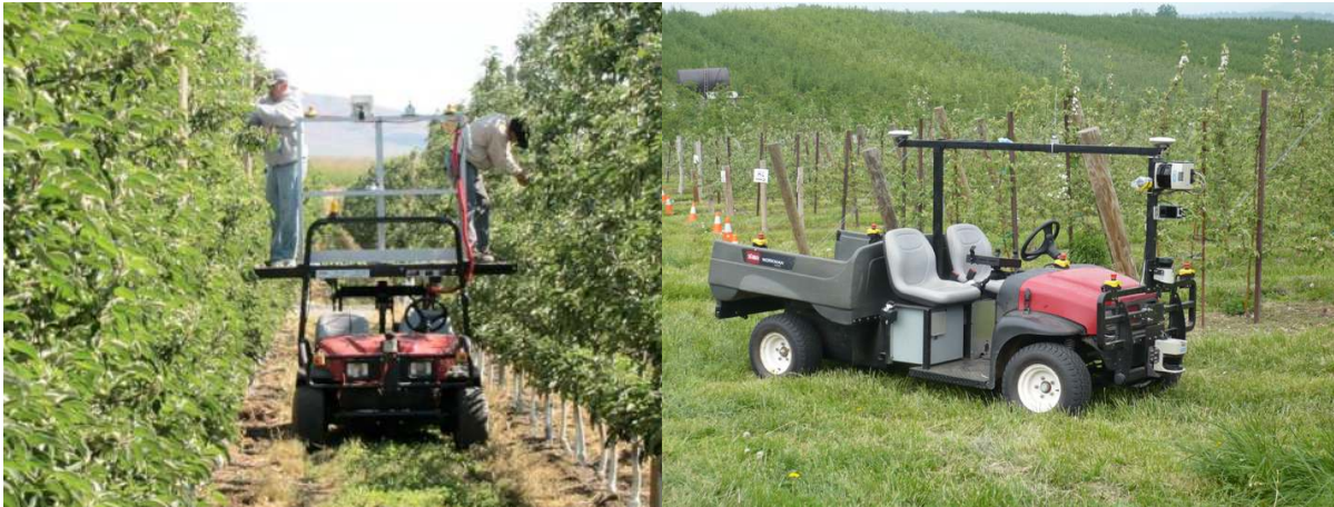
Figura 3.7: Veículo autônomo para o auxílio de colheita em pomares (Bergerman et al. , 2012)
