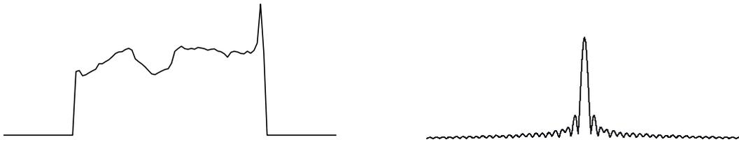
**Figura 2.15:** Valor da Transformada de Radon aplicada ao *phantom* de Shepp-Logan com o ângulo  $\theta = 135^\circ$  e o valor absoluto da Transformada de Fourier desta projeção
