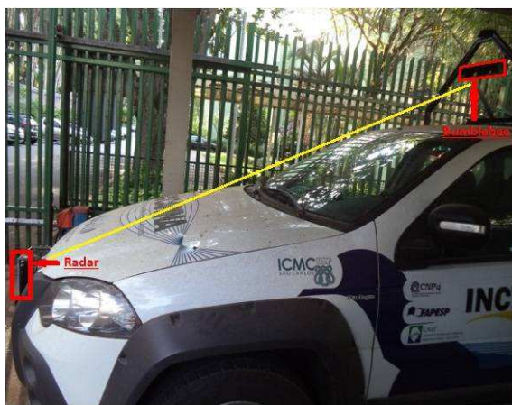
(a) Vista lateral da posição dos sensores
