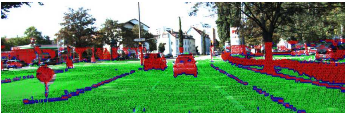
Figura 10 – Resultados do método de detecção de obstáculos no mundo imagem 2D.
