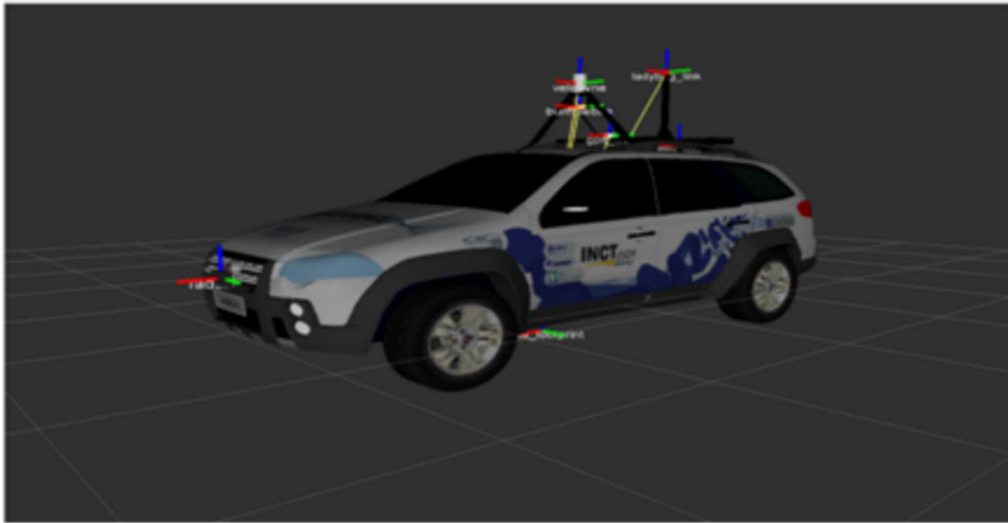
Figura 11 – Pose dos sensores no CaRINA II
