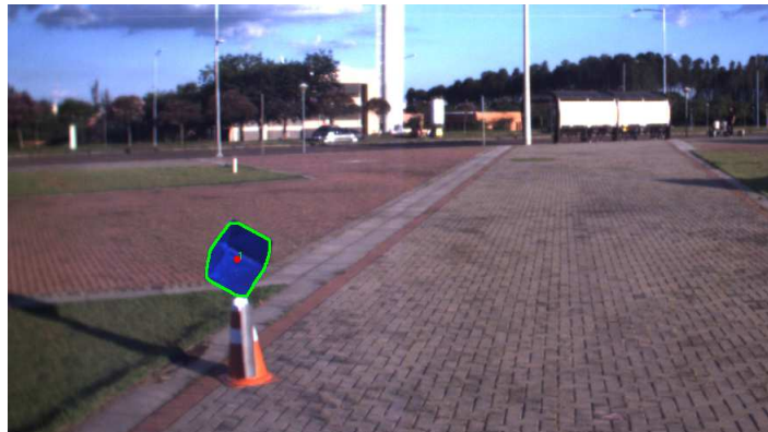
Figura 22 – Detecção baseada em HSV do target na imagem 2D
