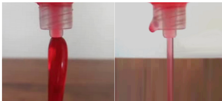
Figura 1.1.1: Ilustração do efeito Barus em um fluido não-newtoniano. Na esquerda, repare que existe um aumento na largura da coluna de fluido que é expulso várias vezes maior que o diâmetro do injetor, caracterizando o efeito citado. Na direita, com um fluido newtoniano, o fenômeno é imperceptível, com a coluna de fluido extrudado mantendo um diâmetro aproximadamente igual ao do bico injetor.
