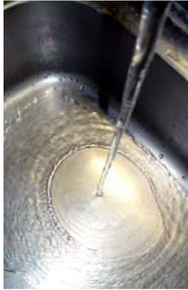
Figura 8.1: Ressalto hidráulico circular. Fenômeno de ressalto hidráulico.
