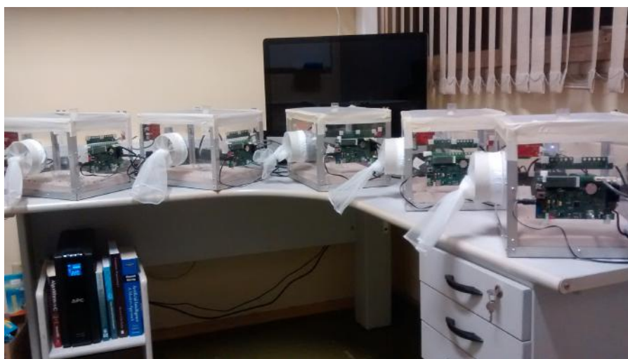
Figura 6.7: Conjunto de insetários adaptados com o sensor utilizados para coleta de dados com mudanças de temperatura. Diferentes insetários permitem a coleta de dados em paralelo de diferentes espécies separadas por sexo.
