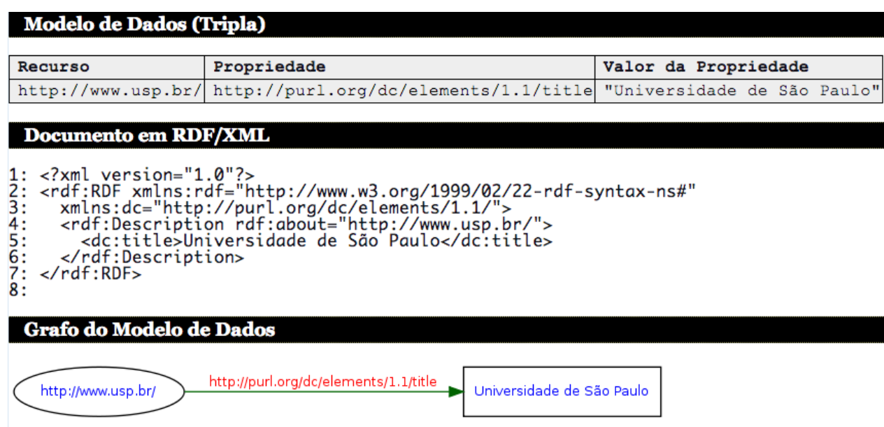
Figura 2.5: Exemplo de modelo de dados, documento RDF/XML e o grafo do modelo de dados.
