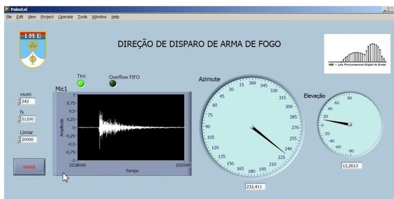
**Figura 6.16** – Sistema de estimação de DOA com base em arranjos de microfones (PRANDEL *et al.*, 2014).
