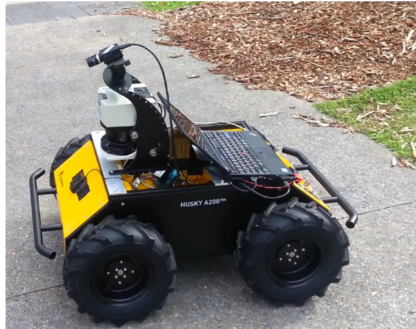
Figura 5.1: Plataforma de teste Husky - Clearpath Robotics (Husky, 2013).
