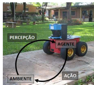
Figura 1.1: Robô móvel autônomo: percepção-decisão-ação (Wolf et al. , 2009).
