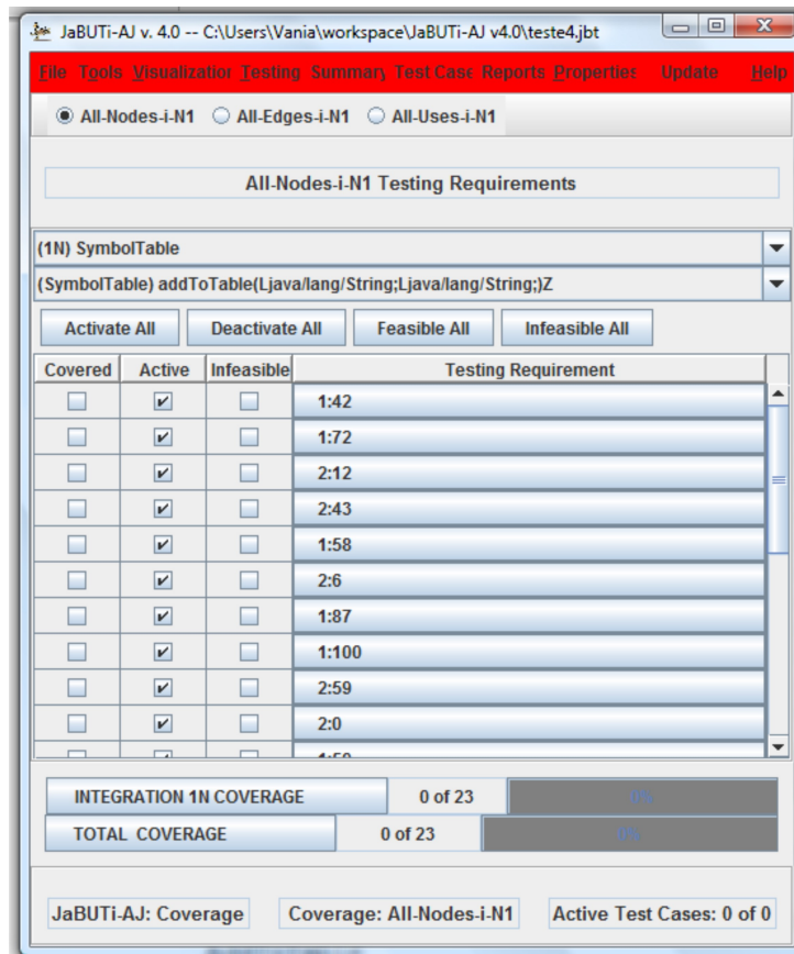
Figura 6.7: Requisitos de teste para o critério todas-arestas-integradas-N1 tendo como base o método addToTable
