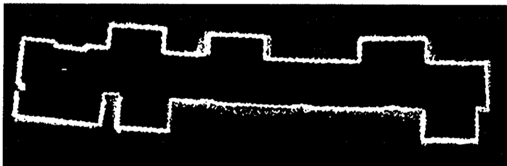
Figura 6.8: Mapa métrico obtido do mapeamento do corredor do prédio de laboratórios do ICMC
