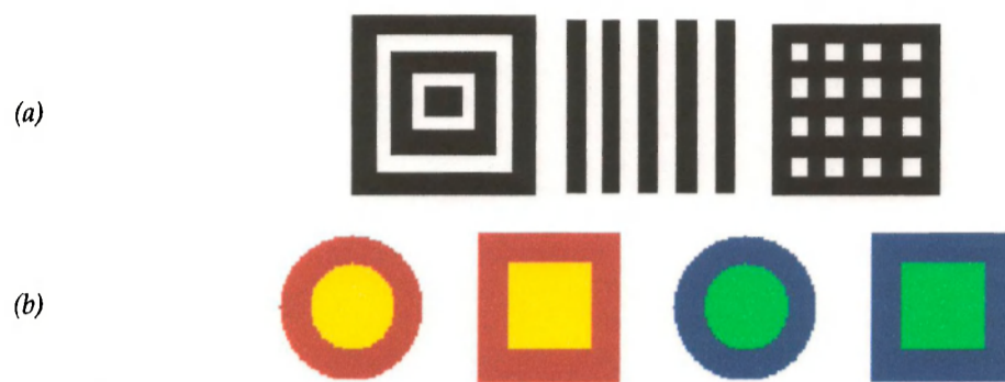
Alguns exemplos de landmarks artificiais. O primeiro conjunto, indicado em (a), composto por três landmarks que se diferenciam única e exclusivamente pelo padrão do desenho. Em (b), landmarks codificados por cores e formas.
