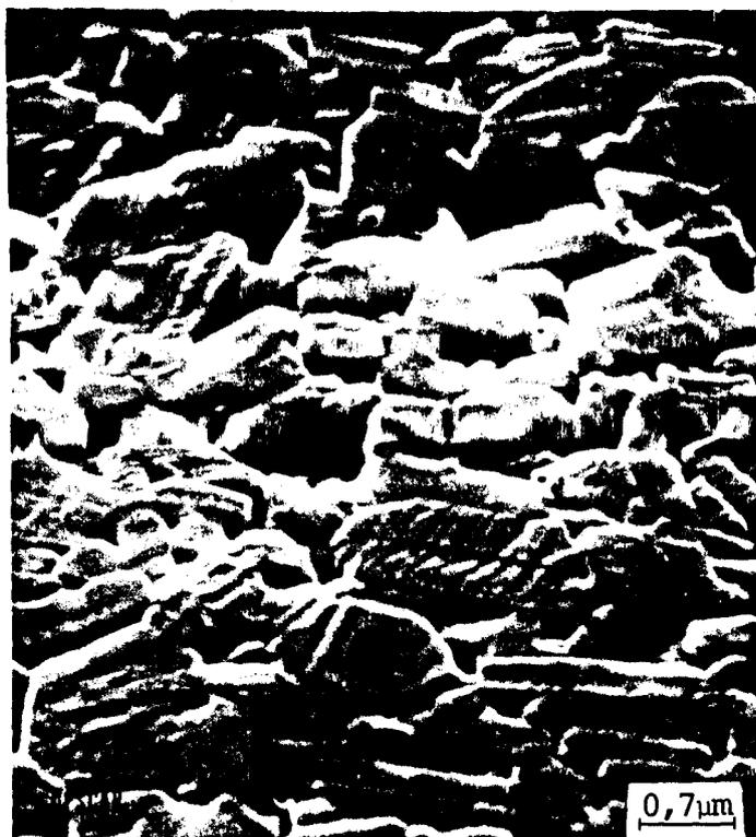
Fig. 4-20 Microestrutura fina típica da alumina- $\beta$ ".
