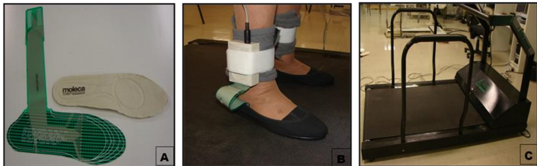
Figura 3. A - Palmilha recortada de acordo com a numeração do calçado. B - Transdutor periférico fixo à extremidade distal da perna através de fitas de velcro. C - Esteira ergométrica elétrica
