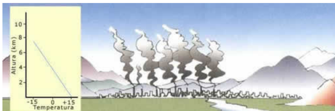
Figura 1 – Condições climáticas normais, sem inversão térmica
