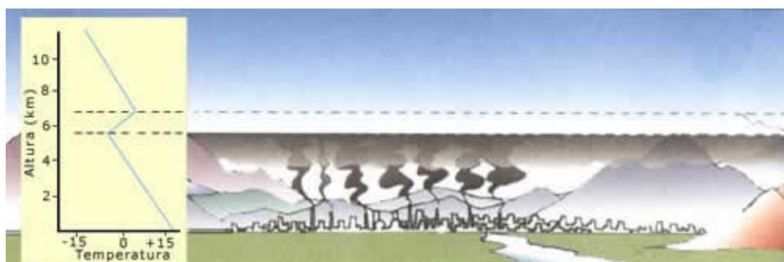
Figura 2 – Condições climáticas com inversão térmica
