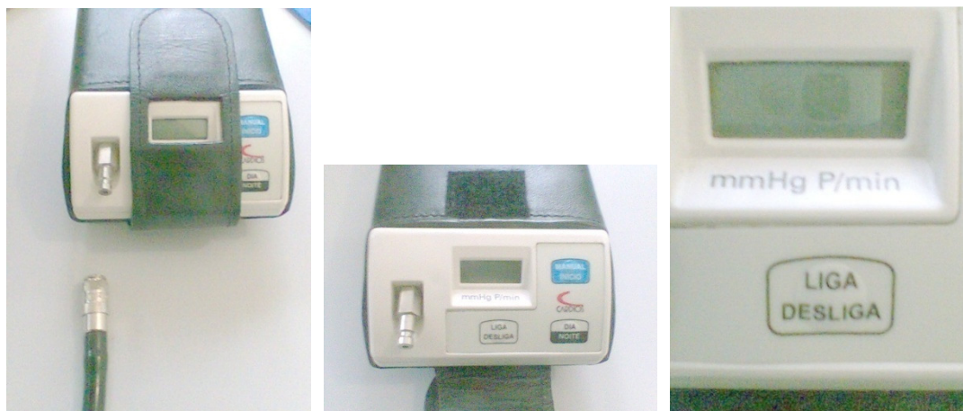
Figura 14 – Aparelho para Monitoração Ambulatorial da Pressão Arterial usado nesta pesquisa (DYNA-MAPA Cardios, modelo 24h ABP-Monitor)
