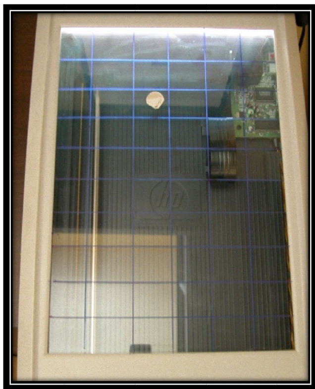
Figura 19. Superfície de digitalização do scanner dividida em 60 campos. Observa-se o objeto metálico a ser digitalizado no centro de um dos campos
