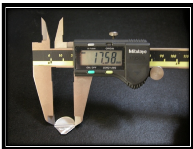
Figura 20. Objeto metálico utilizado para aferir adequação do processo de digitalização tendo sua medida determinada por paquímetro digital.
