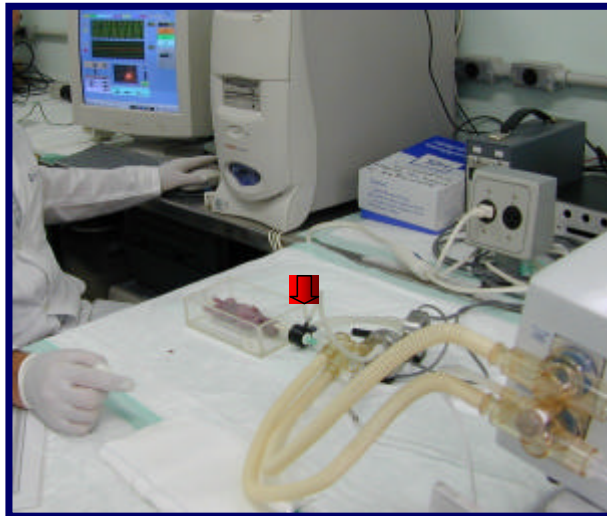
FIGURA 1. Animal conectado ao ventilador mecânico. A seta mostra o pneumotacógrafo acoplado entre a cânula e o circuito do aparelho. Os dados são transmitidos ao computador, via transdutor de fluxo e pressão.
