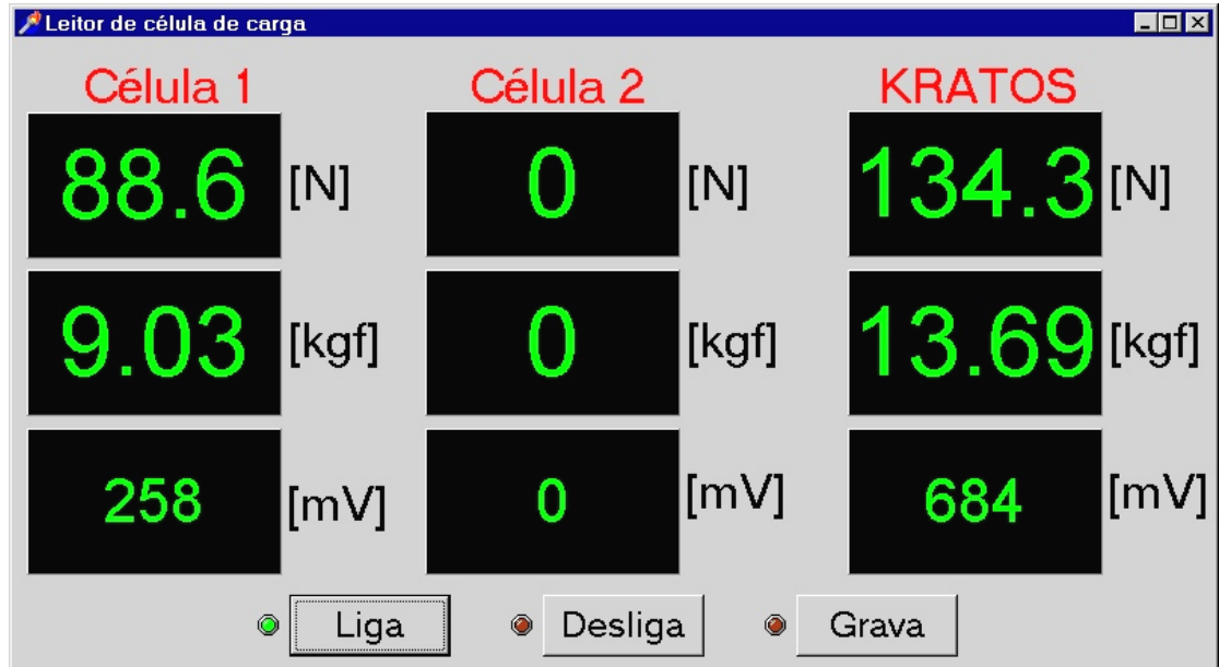
Figura 15. Foto da tela do computador exibindo os valores de tração do enxerto na coluna Célula 1, correspondente ao enxerto quadricipital. A coluna Célula 2 corresponde à tração no enxerto semitendíneo duplo, nula nesta condição de avaliação em específico. A coluna Kratos corresponde ao valor da magnitude da força de sentido posterior aplicada pela máquina de ensaios ao fêmur (anteriorização da tíbia) no momento da fixação dos enxertos, padronizada em 134N
