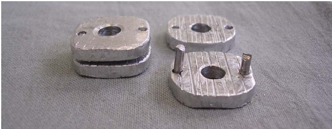
Figura 11. Foto das plaquetas metálicas integrantes do dispositivo de fixação tibial. Montadas à esquerda e desmontadas à direita
