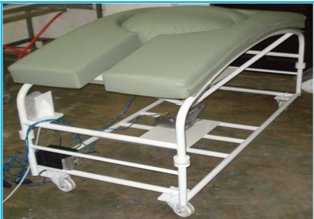
Figura 2 - Protótipo da maca especialmente criada para gestantes - Vista frontal
