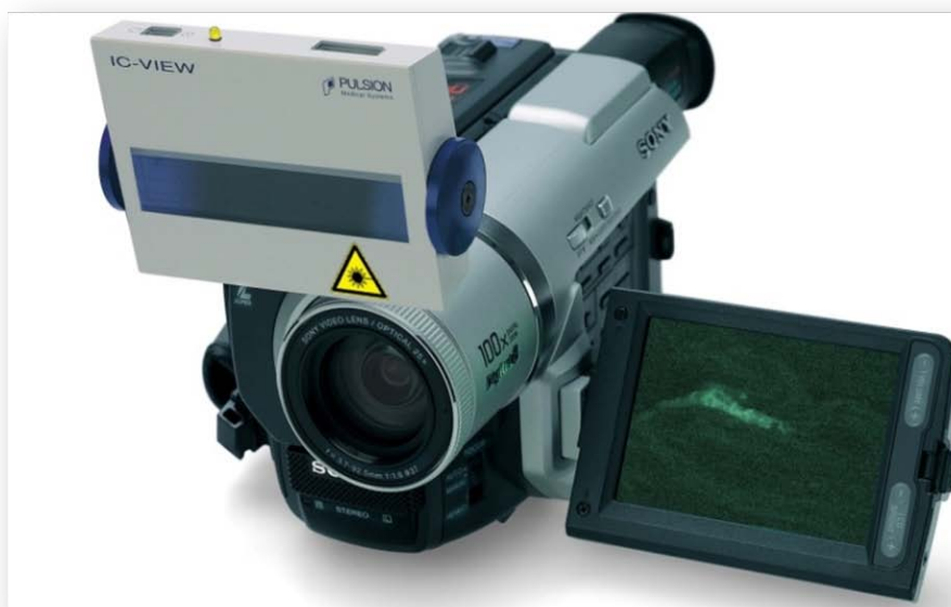
Figura 4. Câmera digital com fonte de luz infravermelha utilizada nos primeiros casos de VAIICG
