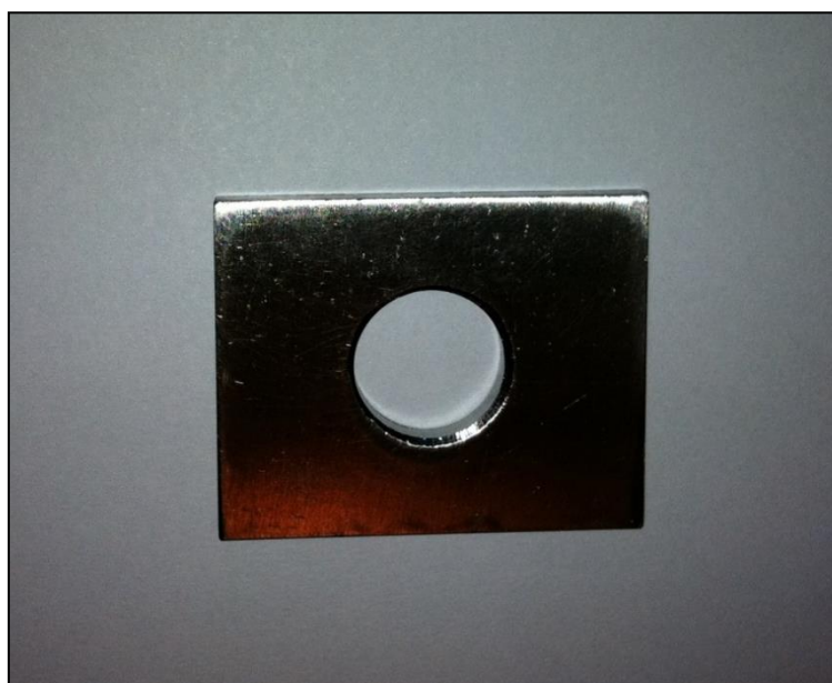
Figura 10 - Placa de aço medidora das amostras de fezes para a técnica de qPCR
