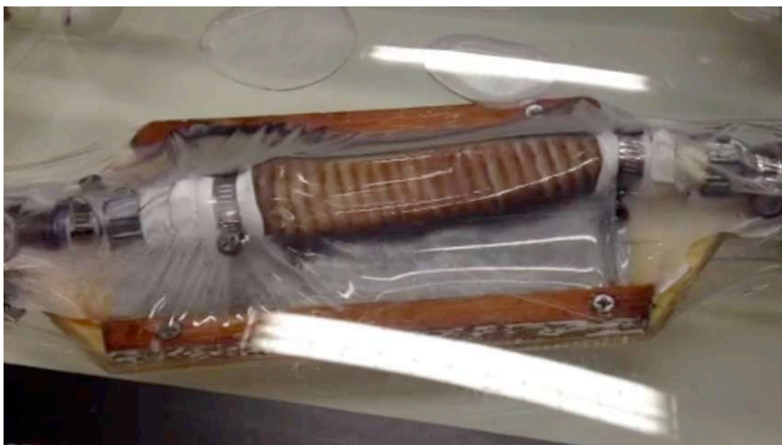
Figura 11 – Fotografia ilustrando o colapamento do espécime (tubo de silicone + Dacron) devido ao aumento da PIA. Vista superior da caixa pressurizável, com a tampa transparente fechada. Durante o registro fotográfico, a PIA era de 200 mmHg.
